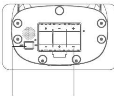
Выключатель    Батарейный отсек
