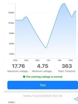
Для начала теста двигатель автомобиля должен быть запущен перед тестированием.
